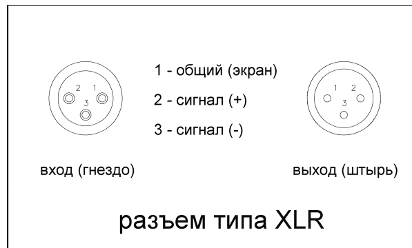
Рис.3. Функциональное назначение выводов разъемов XLR.
